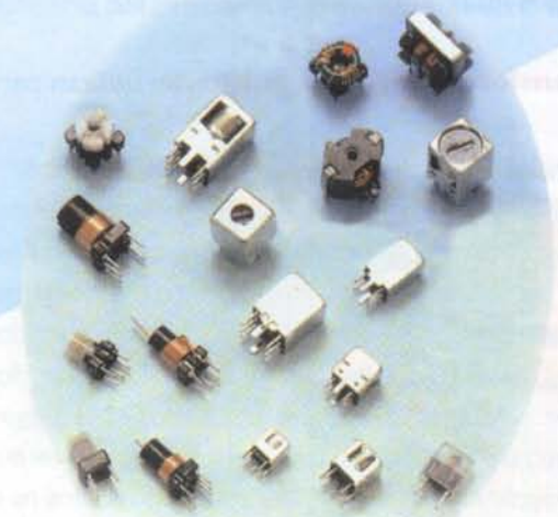
Figura 8.20. Transformadores de radio frecuencia
